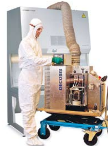
H 2 O 2 Begasung einer BERNER FlowSafe® Sicherheitswerkbank mit SKANAIR®
